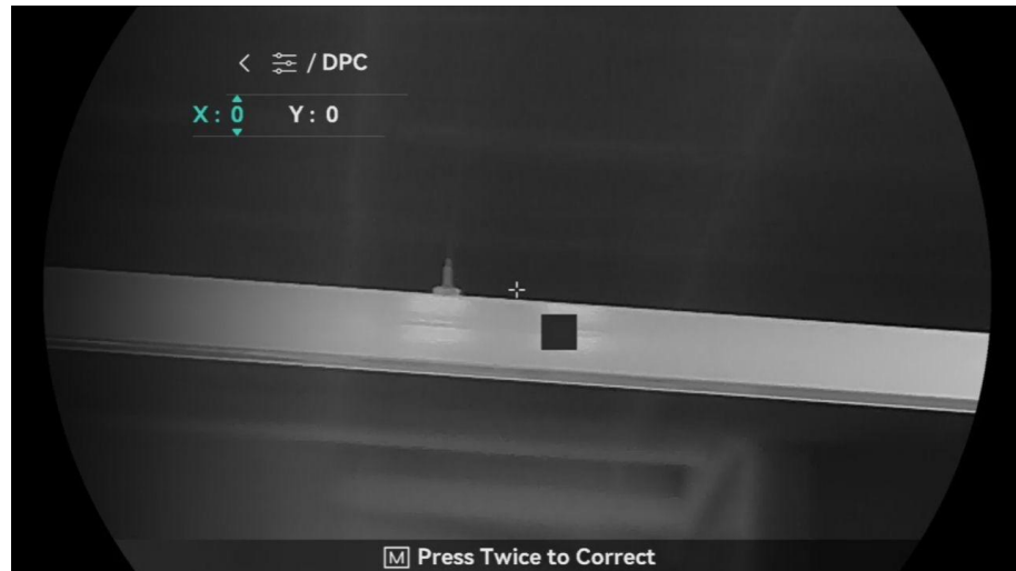
Figur 3-5 Korrigera defekt pixel
