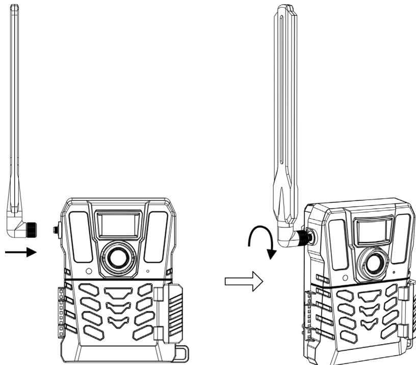
Figura 2-4 Instalar la antena
