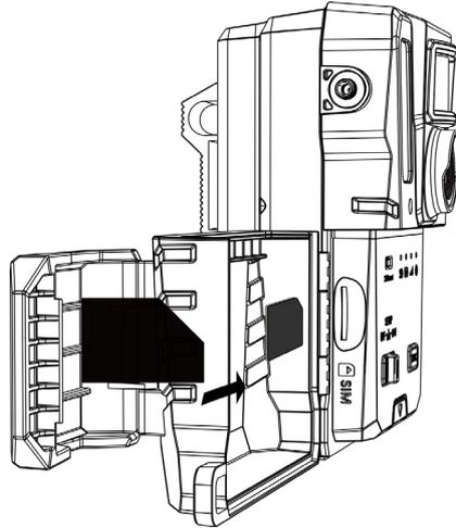
Figura 2-3 Instalar la tarjeta SIM
