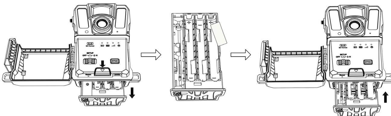
Figura 2-1 Colocar las pilas
