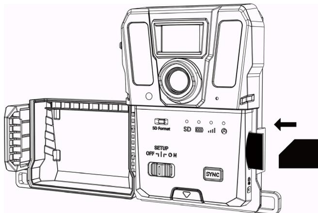
Figura 2-2 Instalar la tarjeta SD
