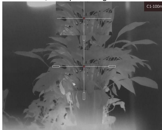
Figure 4-2 Effet PiP dans la correction du réticule
