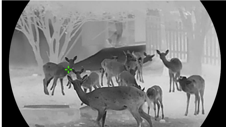
Abbildung 6-2 Stelle mit höchster Temperatur verfolgen
