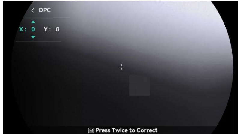
Figur 3-5 Korrigera defekt pixel
