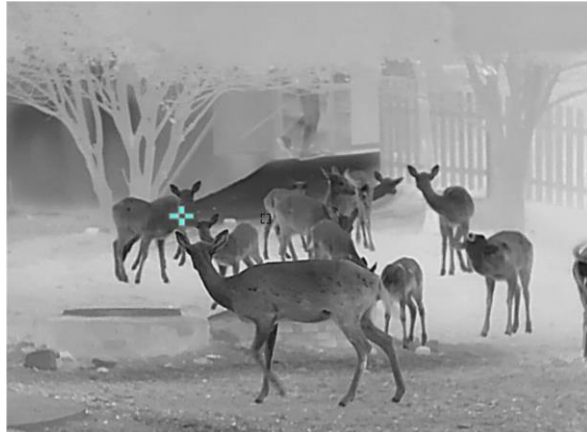
Abbildung 6-3 Stelle mit höchster Temperatur verfolgen
