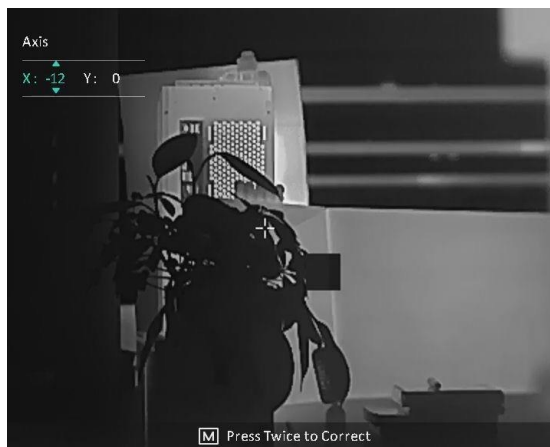
Figura 3-6 Corrección de píxeles defectuosos
