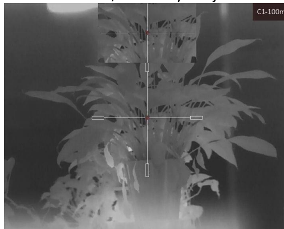
Obrázok 4-2 Efekt obrazu v obraze pri korekcii zameriavacieho kríža
