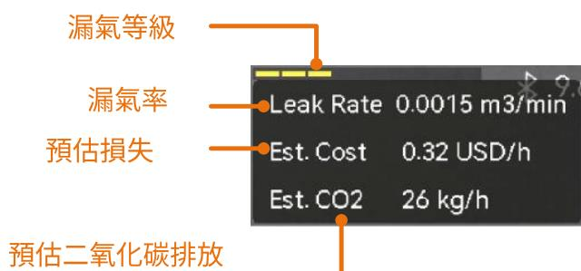
圖 4-1 瓦斯漏氣估算 (壓縮空氣)
