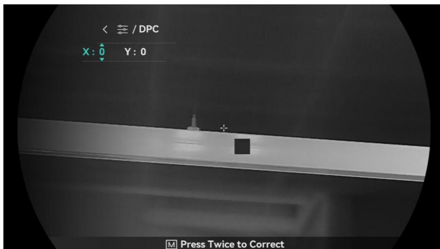
3-5. ábra: Hibás képpontok kijavítása
