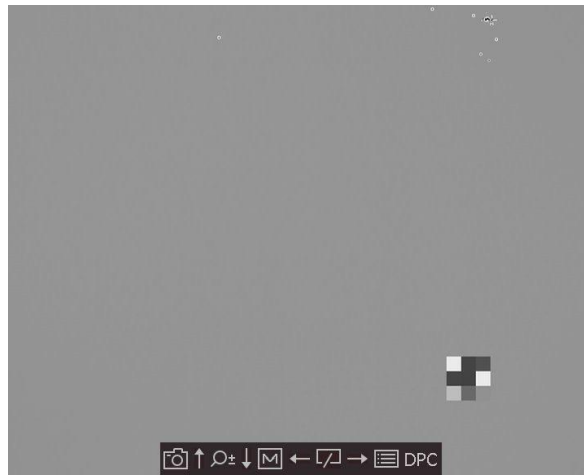
Abbildung 3-2 Defekte Pixel korrigieren
