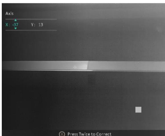
Figure 3-6 Correction de pixel défectueux
