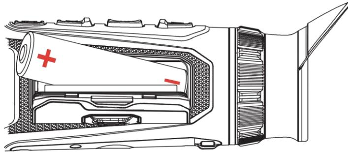
Abbildung 2-2 Einlegen der Batterie
