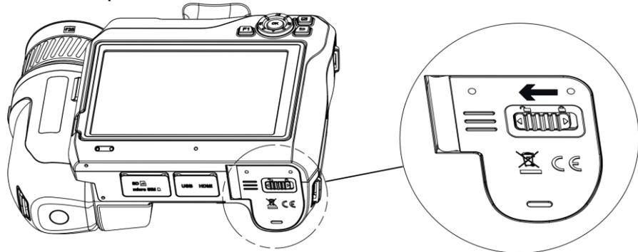
Figure 2-2 Déverrouillage du compartiment de la batterie
