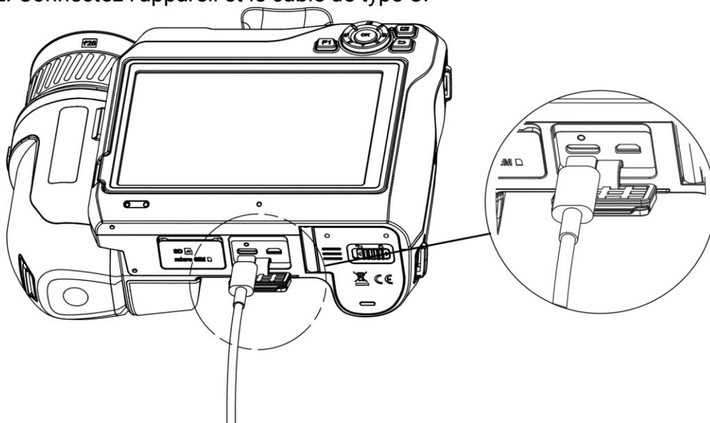
Figure 2-1 Connecter à un câble de type C
