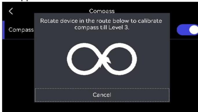
Figure 11-1 Étalonnage de la boussole
