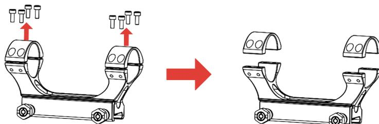
Figure 2-5 Dévissage du haut de la bague
