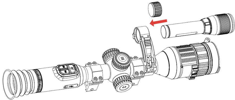
Figure 2-12 Mise en place de la torche IR
