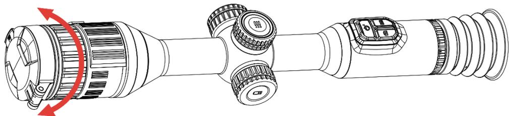
Figure 3-2 Réglage de la mise au point
