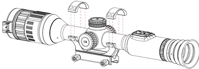
Figure 2-6 Installation de l'appareil dans la bague
