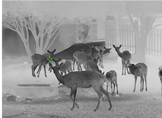
Abbildung 5-2 Stelle mit höchster Temperatur verfolgen
