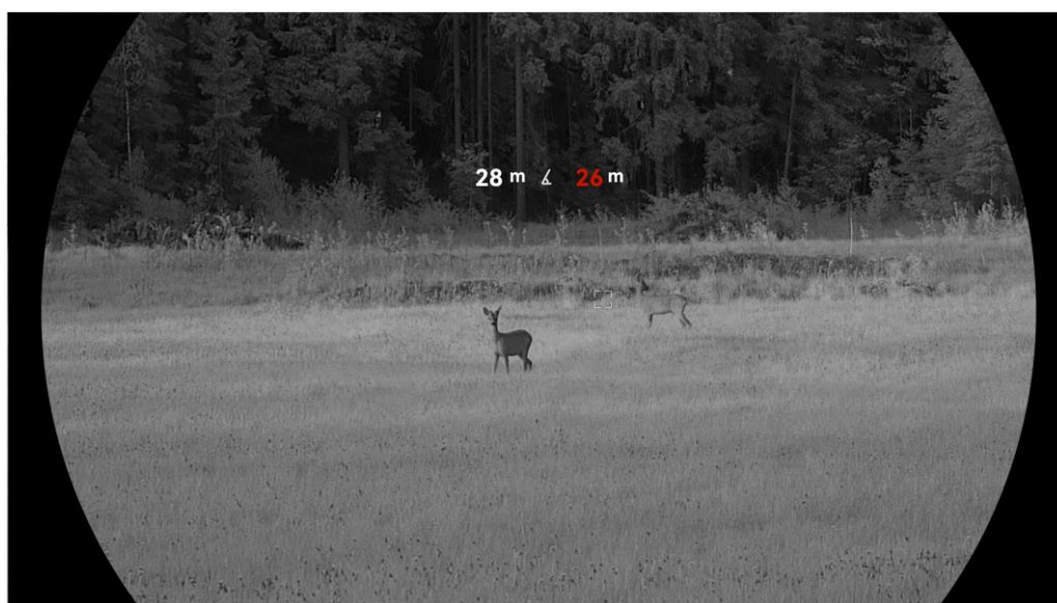
Rysunek 4-1 Wynik laserowego pomiaru odległości
