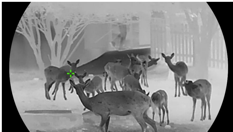
Rysunek 6-2 Śledzenie punktu o najwyższej temperaturze
