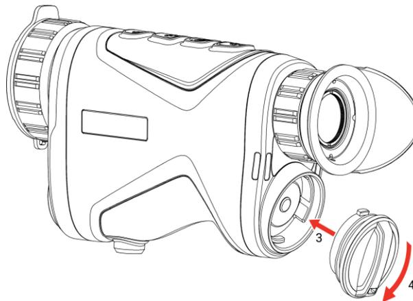
Abbildung 2-3 Abdeckung festziehen
