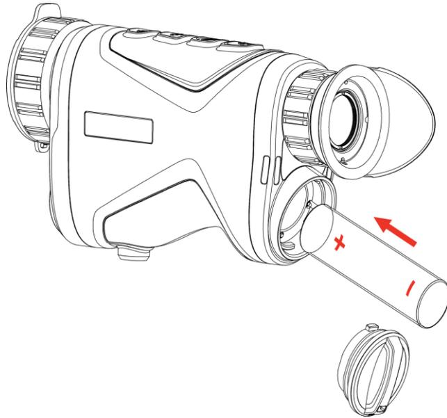
Abbildung 2-2 Den Akku einsetzen
