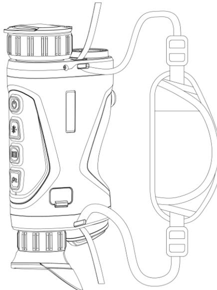
Abbildung 2-5 Die Handschlaufe durch den Befestigungspunkt führen
