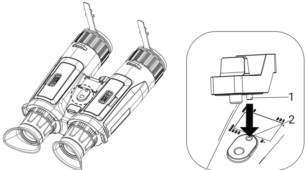
Figura 2-8 Individuazione e inserimento dell'adattatore
