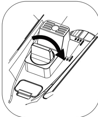
Figura 2-9 Rotazione della vite
