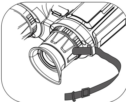
Figura 2-5 Inserimento della tracolla nel punto di attacco
