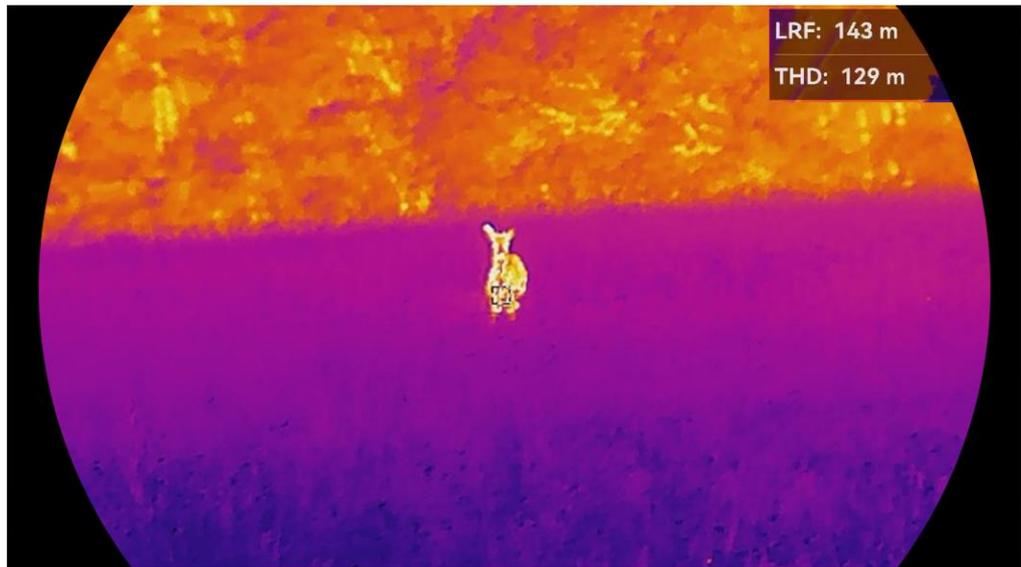
Figura 4-1 Risultato della telemetria laser
