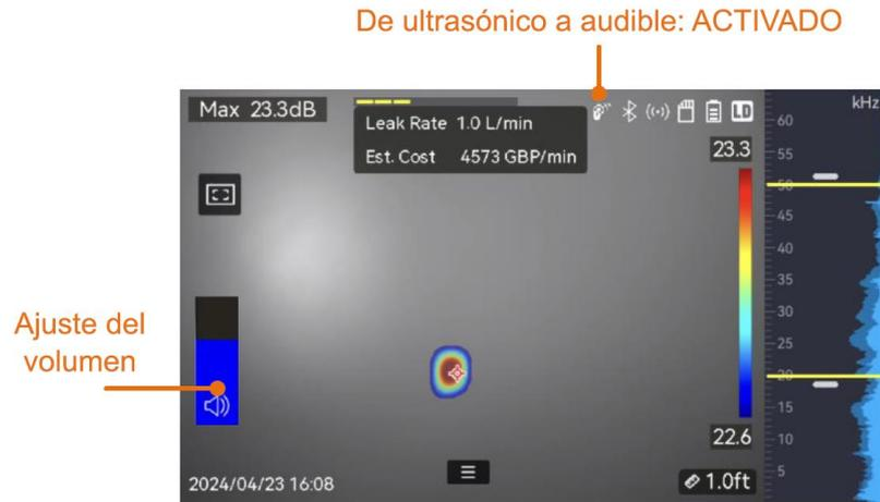
Figura 5-4 De ultrasónico a audible y ajuste de volumen
