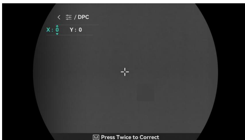
Figura 3-5 Corectarea pixelului defect
