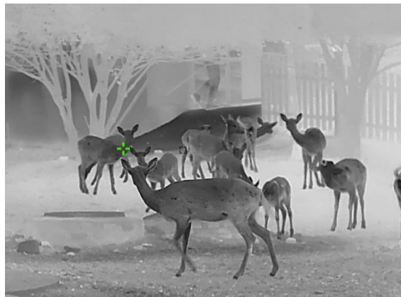
Abbildung 5-3 Stelle mit höchster Temperatur verfolgen
