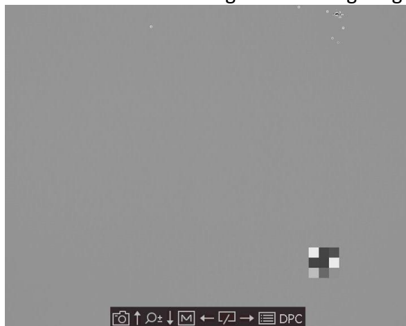
Figur 3-3 Korrigera defekt pixel
