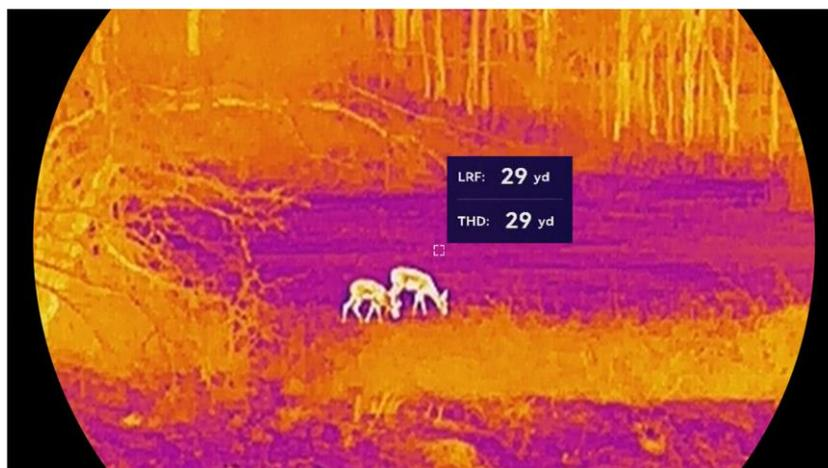
Figura 4-1 Resultado da medição da distância
