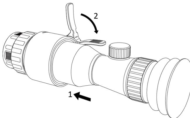
Figura 2-6 Instalación de la mira telescópica diurna
