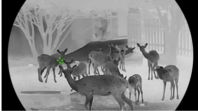
Abbildung 5-2 Stelle mit höchster Temperatur verfolgen
