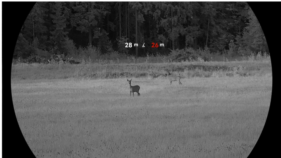
Abbildung 4-1 Ergebnis der Laser-Entfernungsmessung
