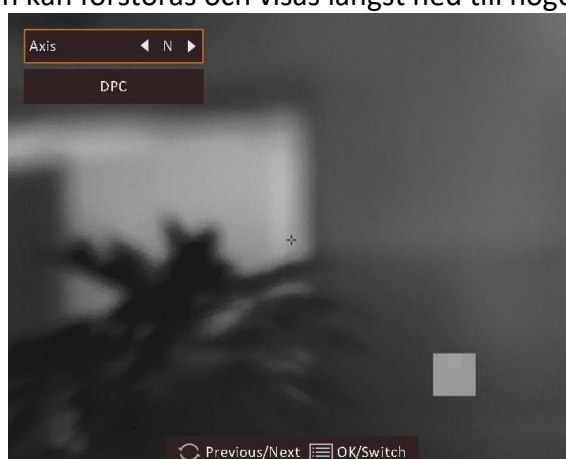
Figur 3-3 Korrigera defekt pixel
