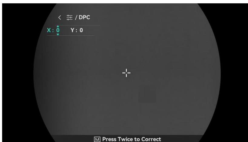
3-6. ábra: Hibás képpontok kijavítása
