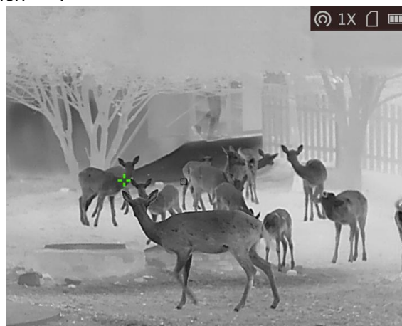
Abbildung 5-3 Stelle mit höchster Temperatur verfolgen
