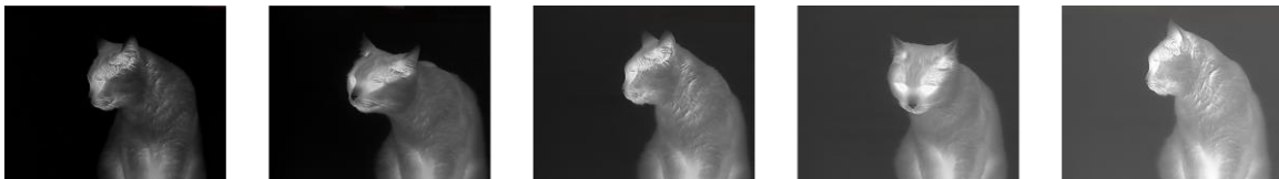
Abbildung 3-1 Helligkeit im Modus „Weißglühend“ einstellen
