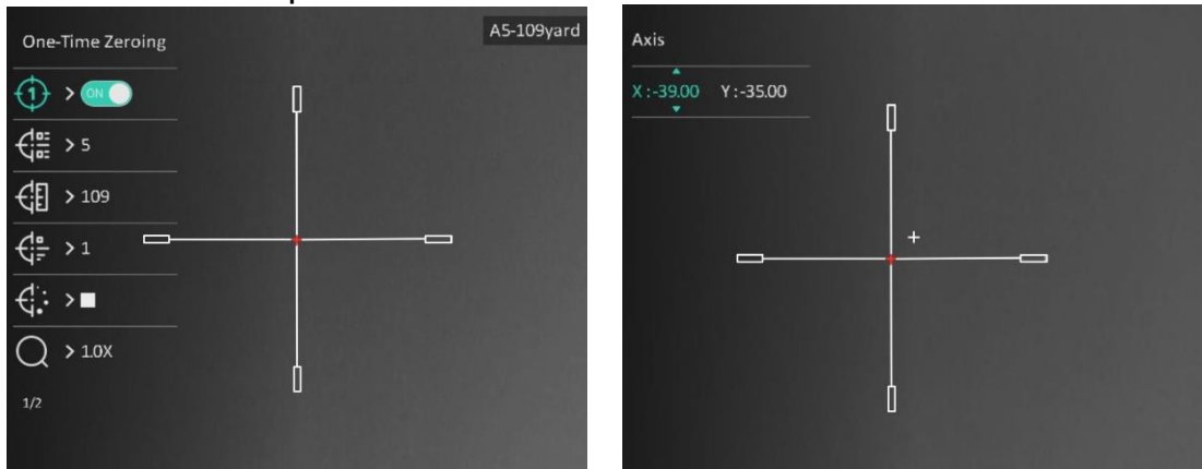
Figure 2-9 Mise à zéro
