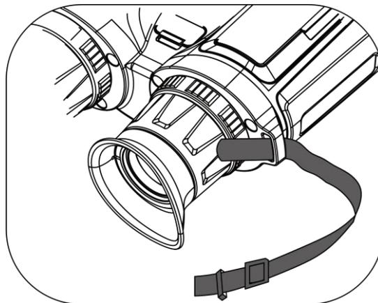
Abbildung 2-5 Den Umhängegurt durch den Befestigungspunkt führen
