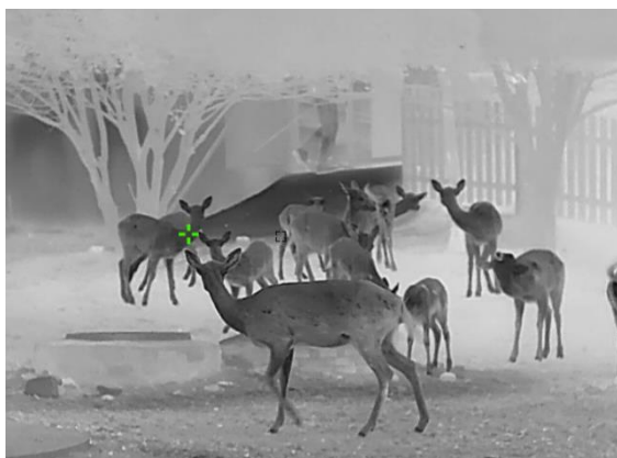
Figura 5-3 Tracciamento del punto più caldo
