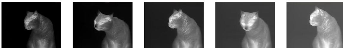
Figura 3-4 Regolazione della luminosità in modalità Caldo bianco
