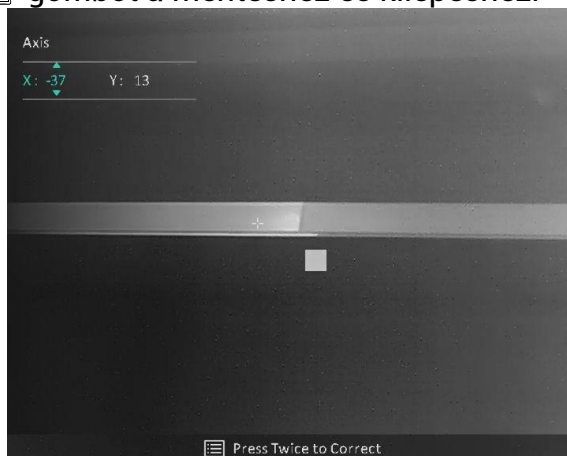
3-4. ábra Hibás képpontok kijavítása
