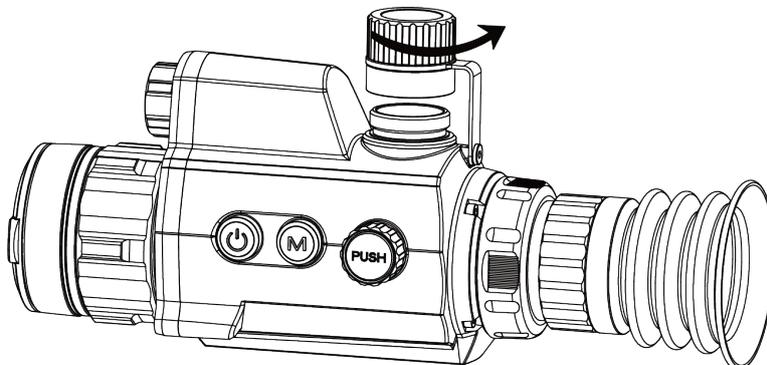
Figura 2-2 Apertura del coperchio del vano batteria
