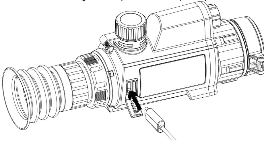
Figura 2-1 Connessione del cablaggio
