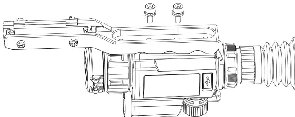
**Figura 2-6 Installazione delle viti**
