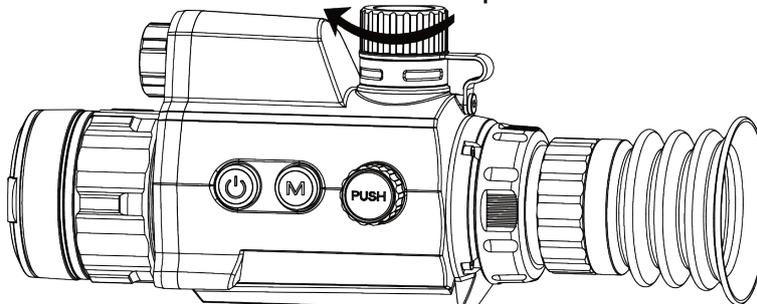
Figura 2-4 Chiusura del coperchio della batteria
