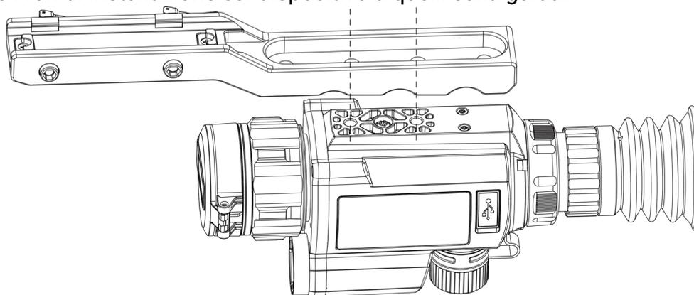
**Figura 2-5 Allineamento dei fori di installazione**
