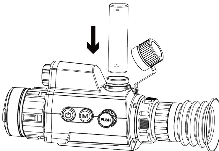
Figura 2-3 Installazione della batteria
