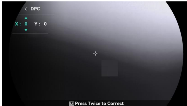
Figur 3-5 Korrigera defekt pixel
