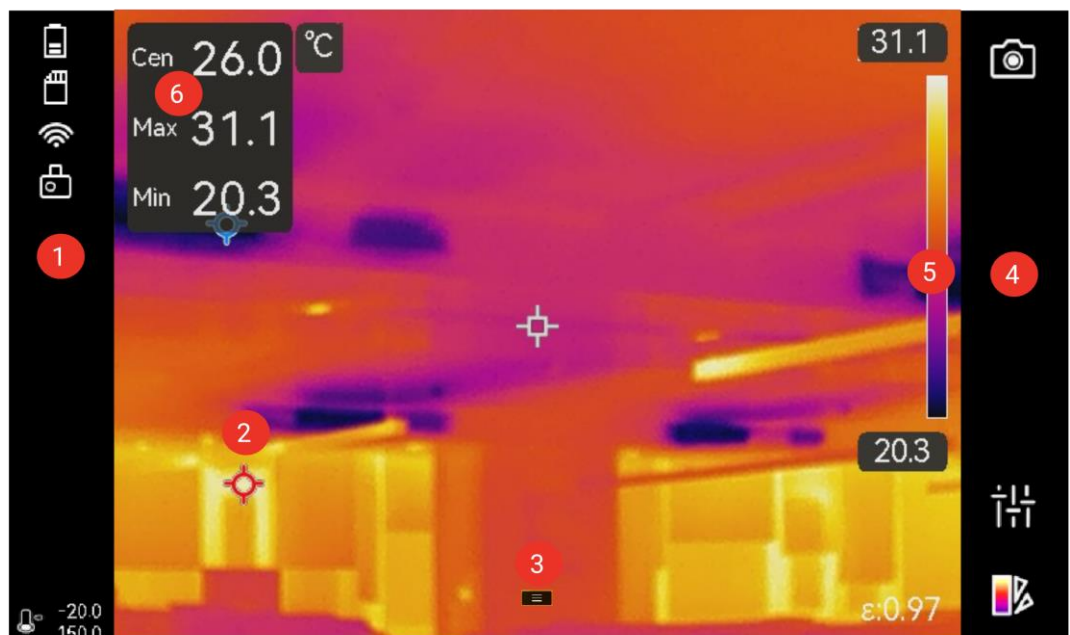
그림 2-11 열화상 이미지 모드의 실시간 보기 인터페이스
