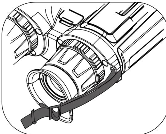
Figura 2-6 Passagem da alça de pescoço pela fivela
