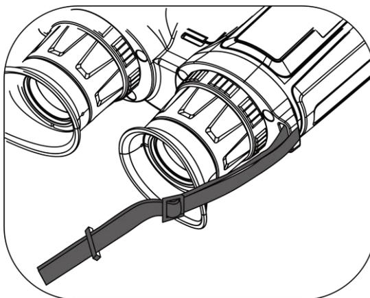
Figura 2-7 Passagem da alça de pescoço pelo fixador
