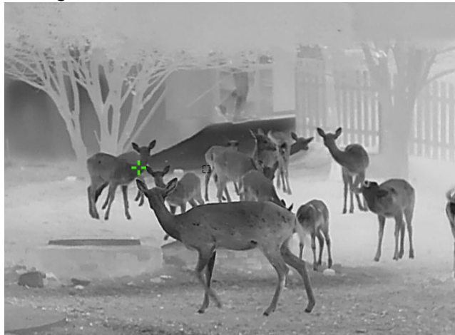
Abbildung 5-5 Stelle mit höchster Temperatur verfolgen
