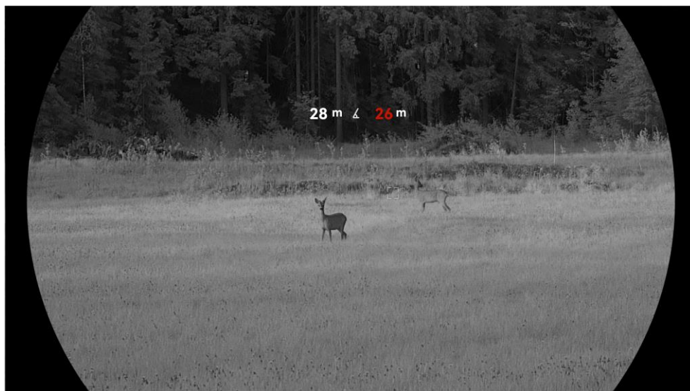
Obrázok 4-1 Výsledok merania vzdialenosti laserom
