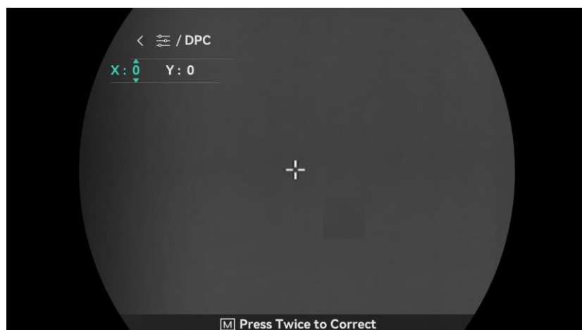
Gambar 3-6 Mengoreksi Piksel yang Cacat
