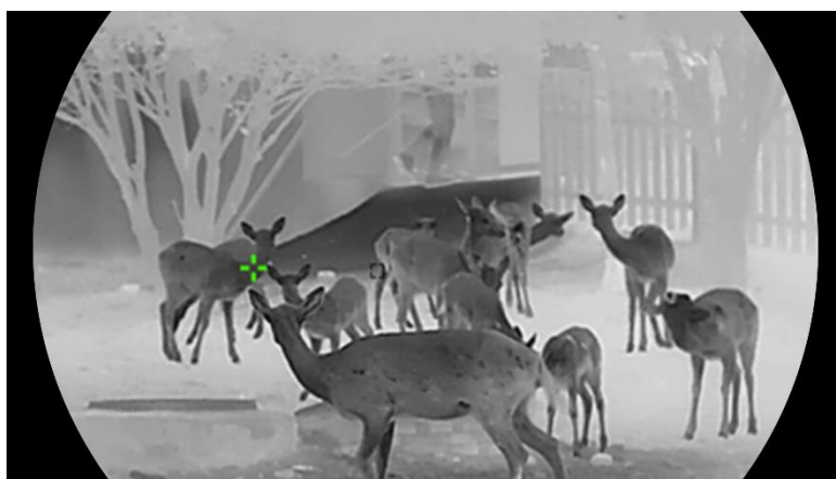
Rysunek 7-1 Śledzenie punktu o najwyższej temperaturze
