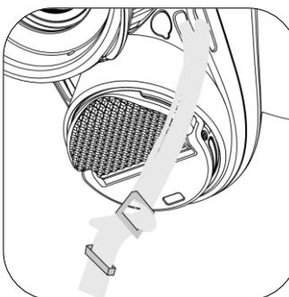
Figura 2-7 Passagem da alça de pescoço pela fivela
