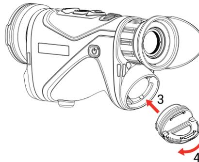
Figura 2-3 Fecho da tampa do compartimento da bateria
