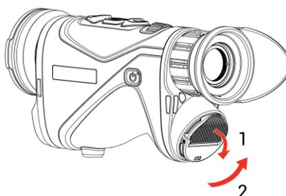
Figura 2-1 Abrir a tampa do compartimento da bateria
