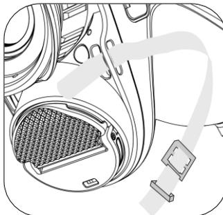
Figura 2-6 Passagem da alça de pescoço pelo ponto de fixação
