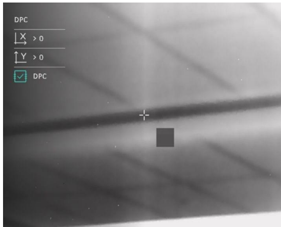
Abbildung 3-4 Defekte Pixel korrigieren
