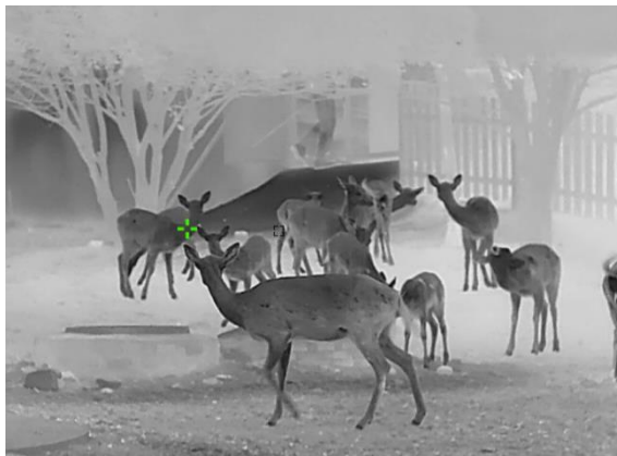
Abbildung 7-2 Stelle mit höchster Temperatur verfolgen
