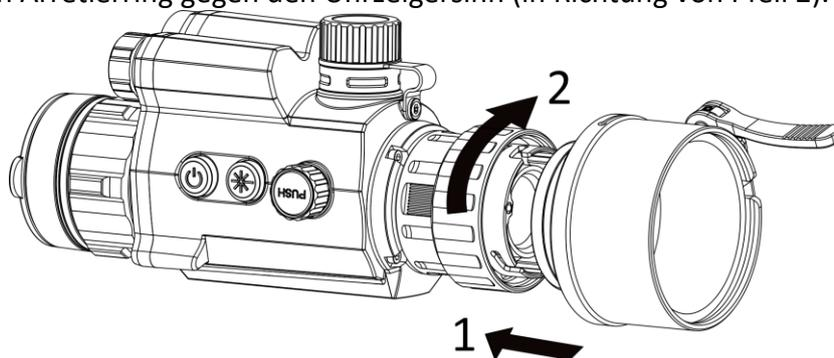
Abbildung 2-2 Adapter montieren
