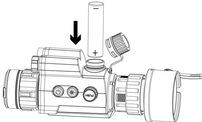
**Abbildung 2-5 Akku einsetzen**
