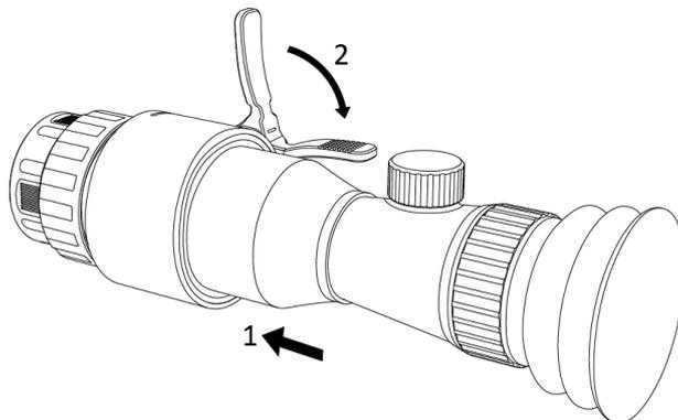
Abbildung 2-3 Tageslichtzielfernrohr montieren
