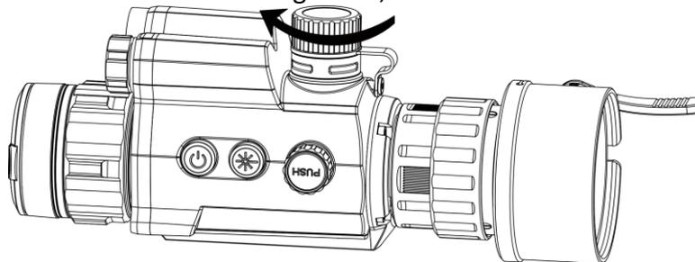
**Abbildung 2-6 Batterieabdeckung schließen**
