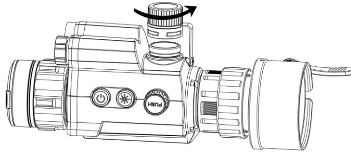
**Abbildung 2-4 Batterieabdeckung öffnen**
