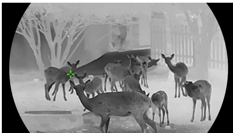
Rysunek 6-1 Śledzenie punktu o najwyższej temperaturze
