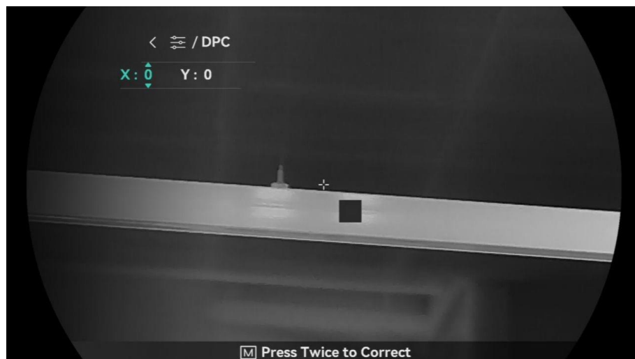
Obrázok 3-5 Korekcia chybných pixelov
