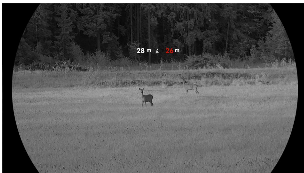
Obrázok 4-1 Výsledok merania vzdialenosti laserom
