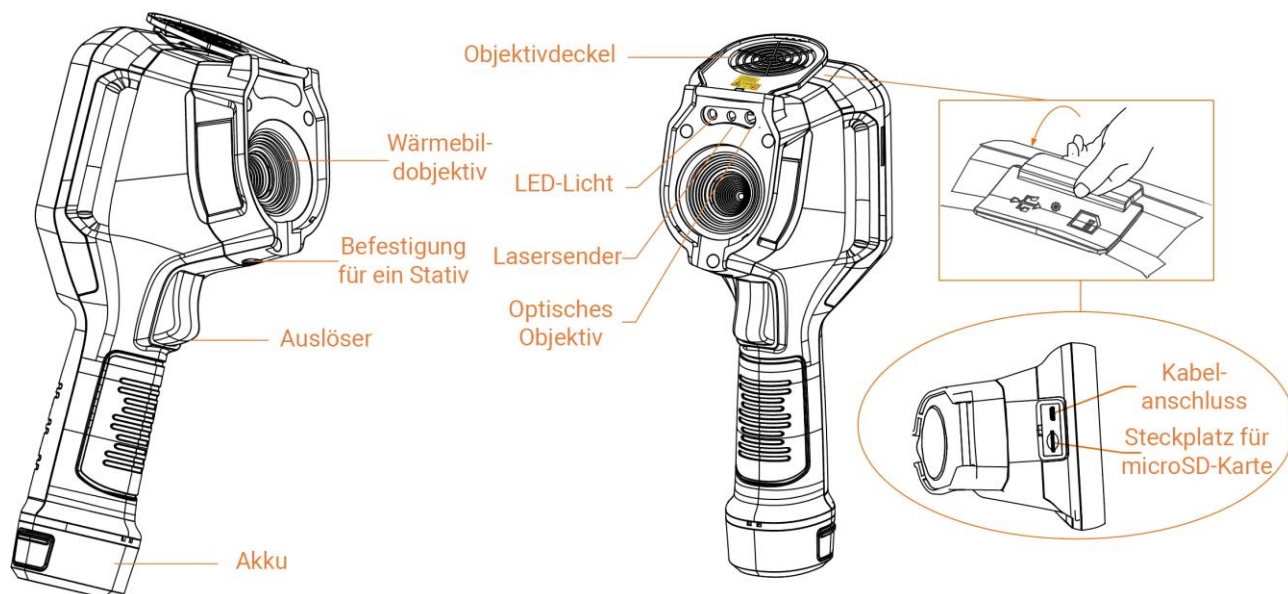
Abbildung 1-3 Aufbau (Seitenansicht) II
