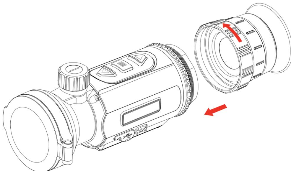
Figura 2-5 Installazione dell'oculare
