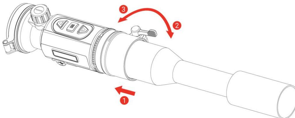
Figura 2-7 Installazione del mirino per luce diurna
