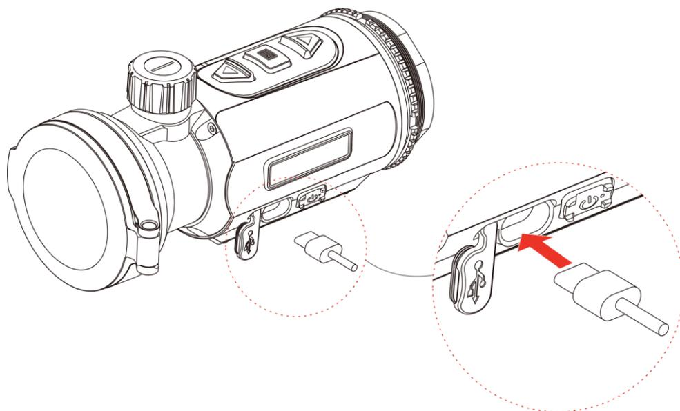
Figura 2-4 Connessione USB
