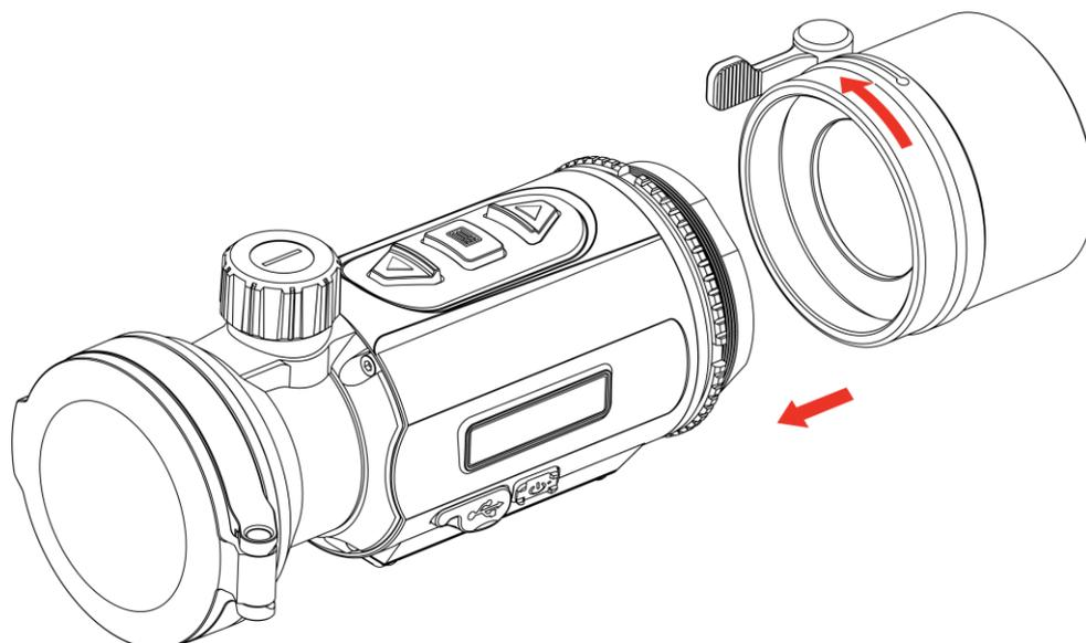
Figura 2-6 Installazione dell'adattatore
