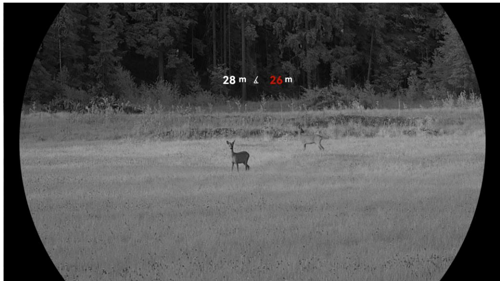
4-1. ábra: Lézeres távolságmérés eredménye
